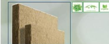
Composizione: 90% fibra di canapa industriale 10% fibre bicomponenti; densità: 25,5 kg/m<sup>3</sup>; conducibilità termica: 0,040W/mK reazione al fuoco: 0+1, d1; ritardanti di fiamma (r19%); sale di ammonio; colore specifico: 1800 J/kgK
