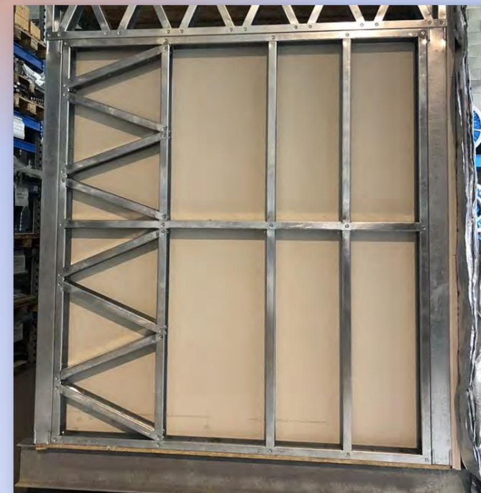
A questo punto l'assemblaggio dei componenti diventa estremamente rapido e preciso (anche tenendo conto di tutte le lavorazioni effettuate in automatico sui profili per le connessioni)
