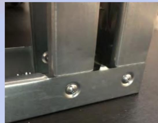
Inoltre, questo sistema garantisce la complanarità delle superfici esterne del componente (prevede anche la realizzazione automatica dell'incavo per accogliere la teste delle viti)
